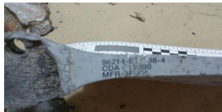
Figura X Fragmento de alerón del sistema de guía de GBU-12 Paveway II donde se observa código de empresas y organismos (CAGE del fabricante 3FU05) 135
