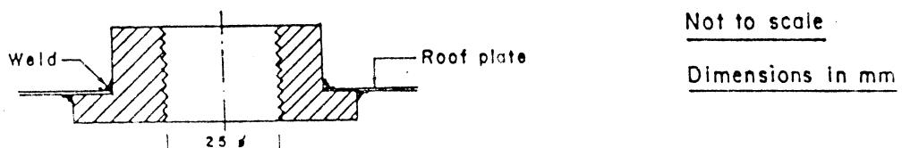
SECTIONAL ELEVATION OF GAS OUTLET FLANGE
